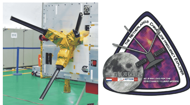
图10 (网络版彩图)中国和荷兰合作的低频射电探测仪载荷
