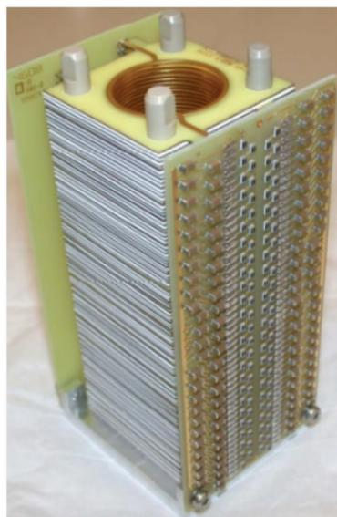
图 8 Agilent 科技有限公司设计的离子漏斗<sup>[38]</sup>
